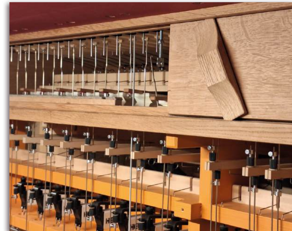
Geöffnete Windlade mit Tontraktur
