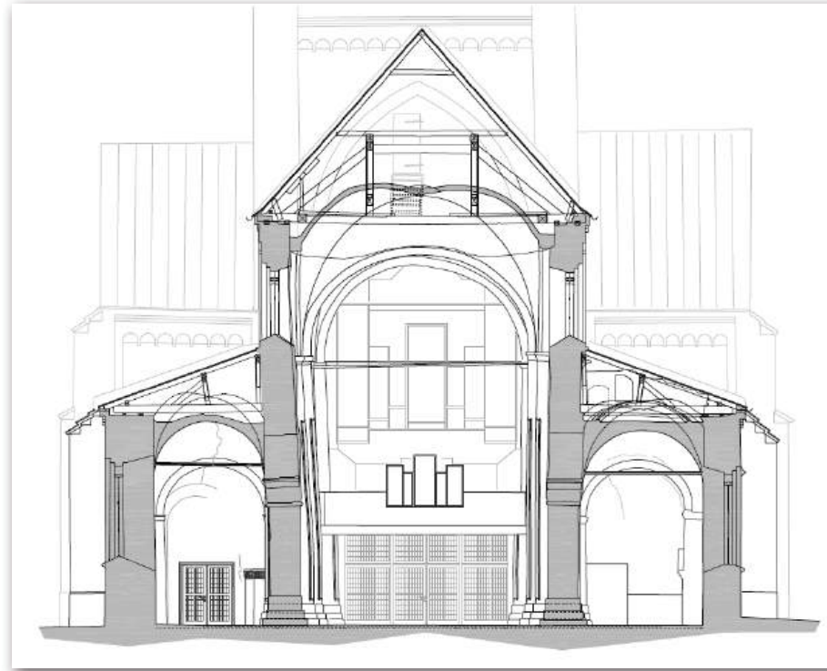
Querschnitt Bestandsaufnahme Dr.-Ing. Bernd Adam Das Mauerwerk des Mittelschiffs neigt sich nach außen.
